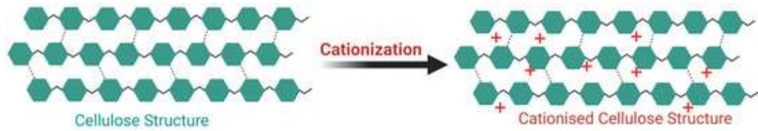
Рисунок 1.9 – Схематическое изображение катионизированной целлюлозы [81].
