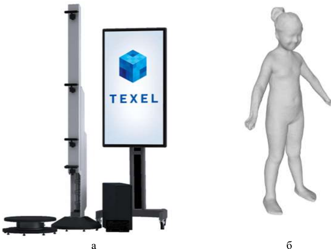
Расми 2. – Сканери 3D Texel Portal MX: а-намуди зоҳирӣ, б-визуализатсияи натиҷаҳои ченкунӣ
