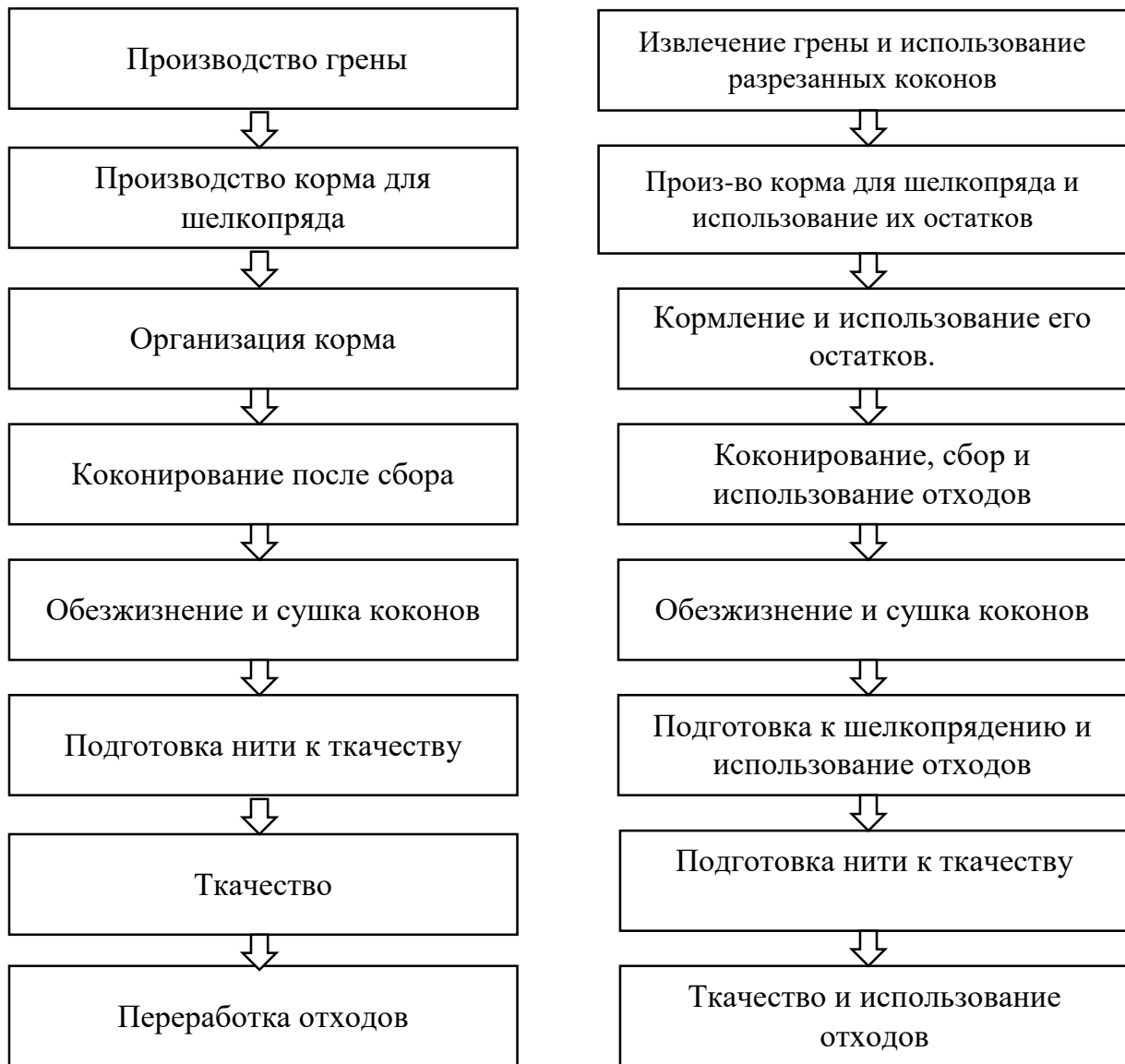
Рисунок 6. - Схема технологических этапов производства и первичной переработки коконов и получения натурального шелка
