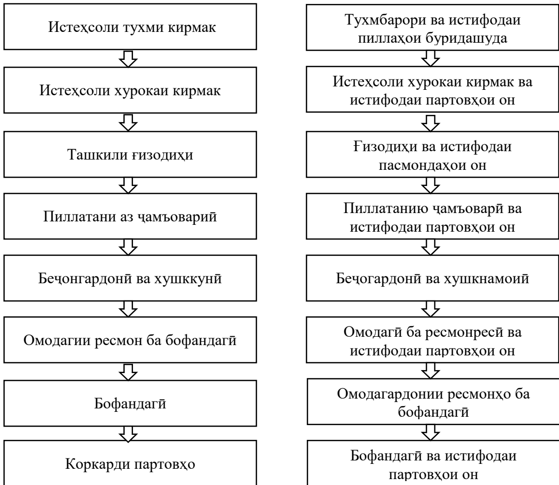
Расм 6. - Тархи марҳилаҳои технологияи истеҳсол ва коркарди аввалияи пилла ва истеҳсоли абрешими табиӣ
