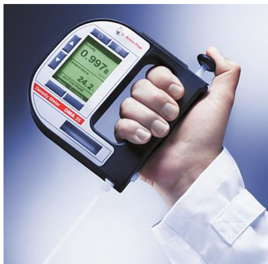
Расми 2. Таҷҳизоти зичисанчи денситометри тамғаи Dencity Metter Anton Paar DMA 35
