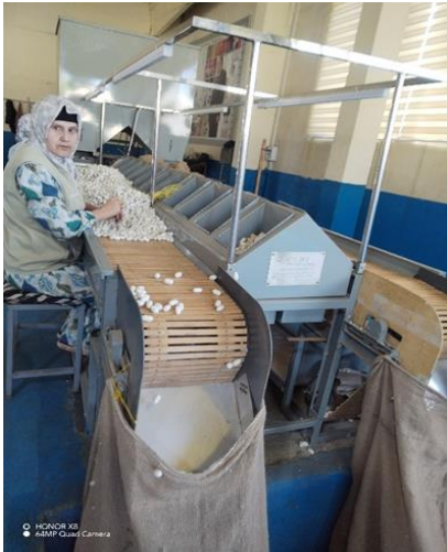
Расми 3.6. Аппарати навъбандии пиллаҳои хом (ширкати «Силк» Чин)
