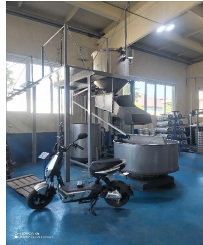
Расми 3.7. Аппарати буғдиҳии пиллаҳои хом (ширкати «Силк» Чин)
