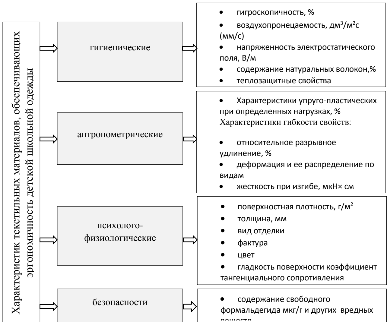
Рисунок 4.1 – Схема, отображающая функциональные связи критериев эргономического соответствия школьной форменной одежды и единичных показателей свойств материалов
