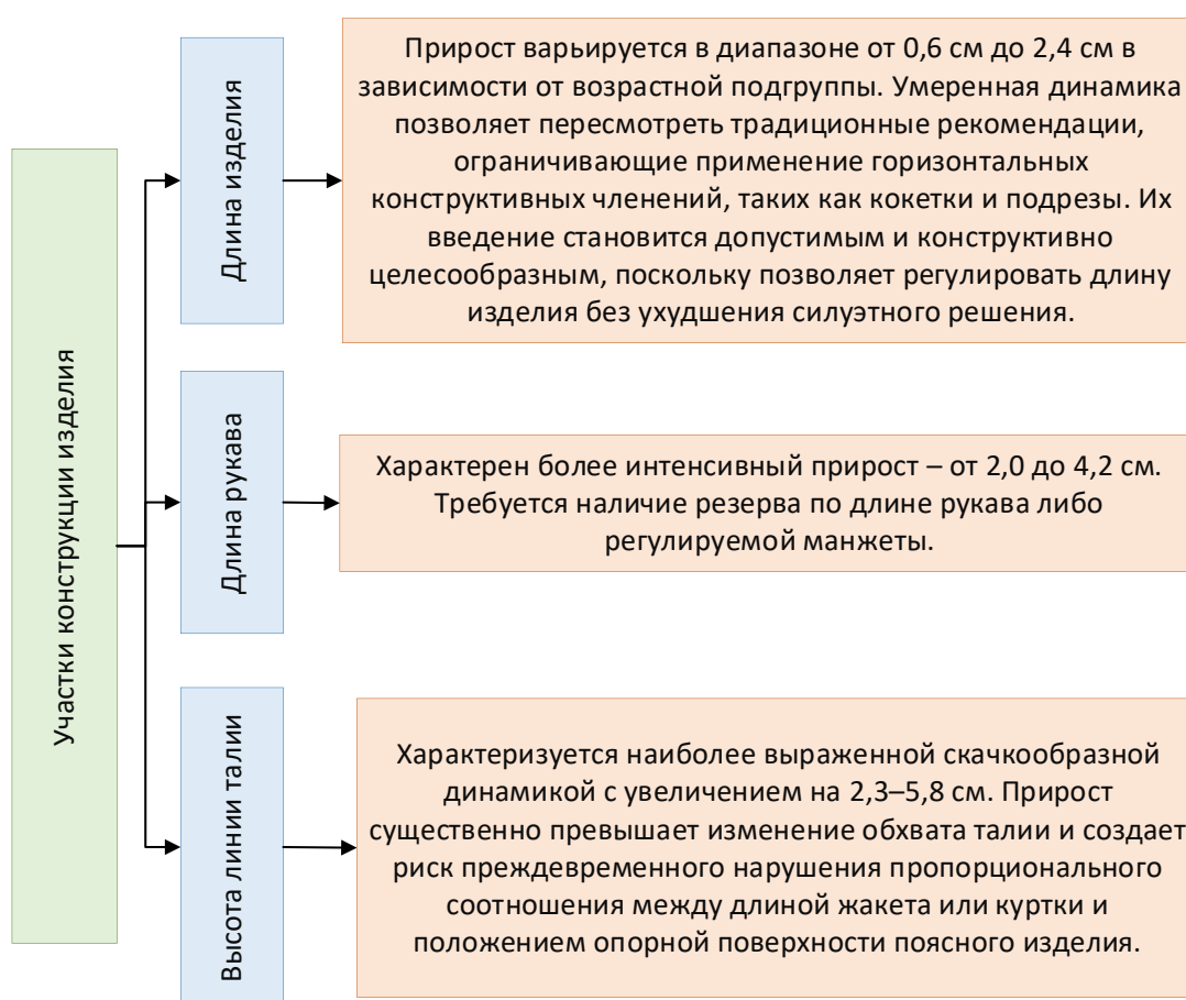
Рисунок 3.3 – Основные закономерности учёта динамики антропометрических данных при разработке плечевой одежды для мальчиков младшего школьного возраста
