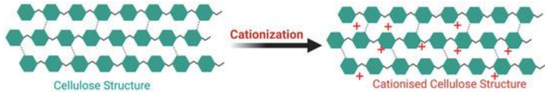
Рисунок 1.9 – Схематическое изображение катионизированной целлюлозы [81].
