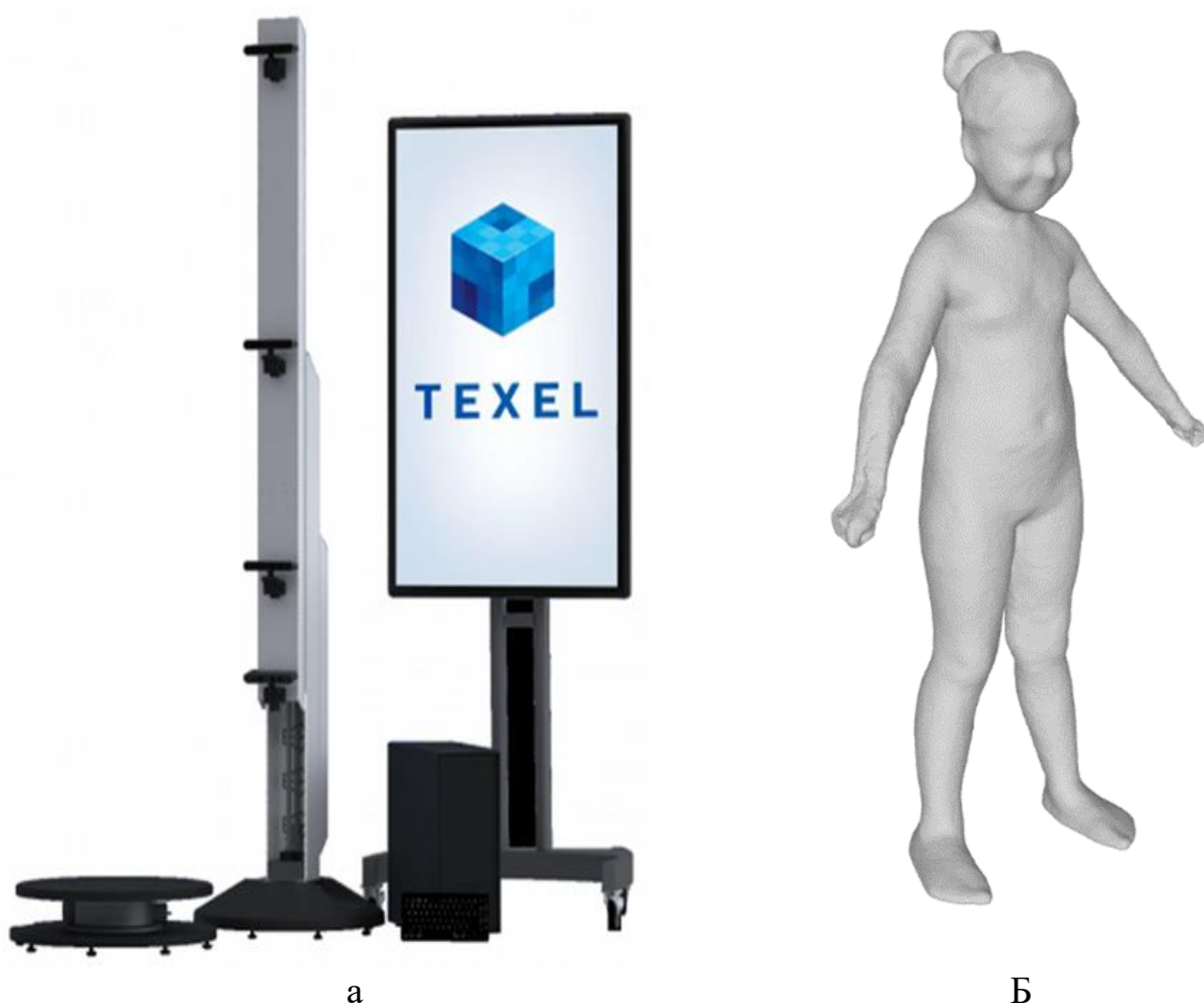
Рисунок 2 – 3D сканер Texel Portal MX: а - внешний вид, б – визуализации результатов измерений
