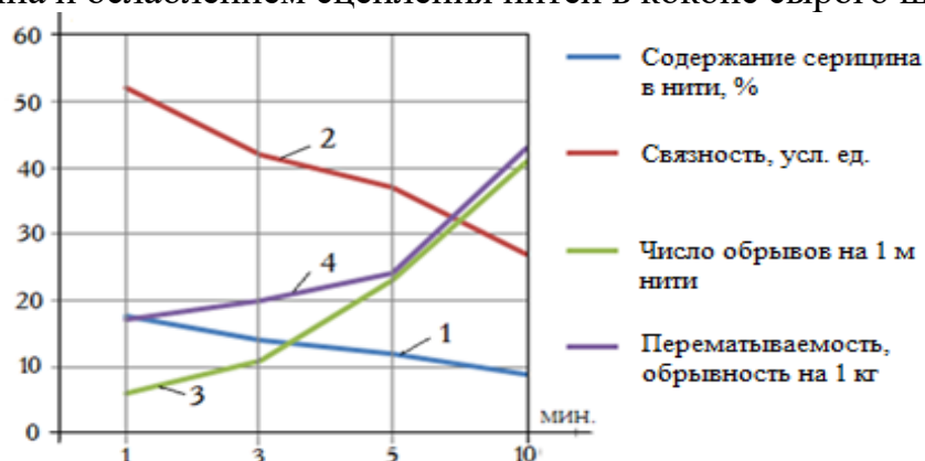
Рисунок 9. – Зависимость показателей натурального шелка от времени пропаривания
