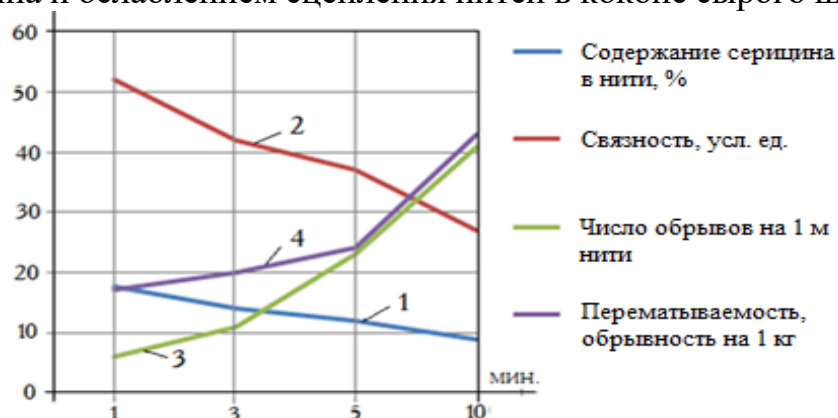
Рисунок 9. – Зависимость показателей натурального шелка от времени пропаривания
