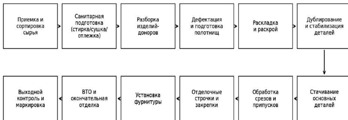
Рисунок 1. Блок-схема технологического процесса повторного использования денима
