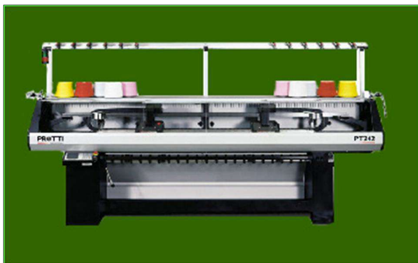
Рисунок 1. Плосковязальная машина марки PROTТИ типа PT242
