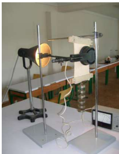
Рисунок 2 - Испытание на светопроводности образца из трикотажного полотна
