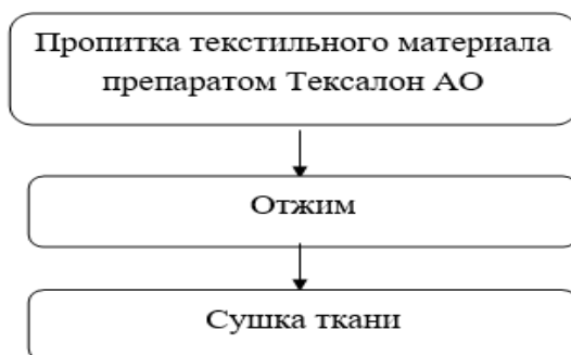
Рисунок 3. Технологические стадии процесса ароматной отделки ткани
