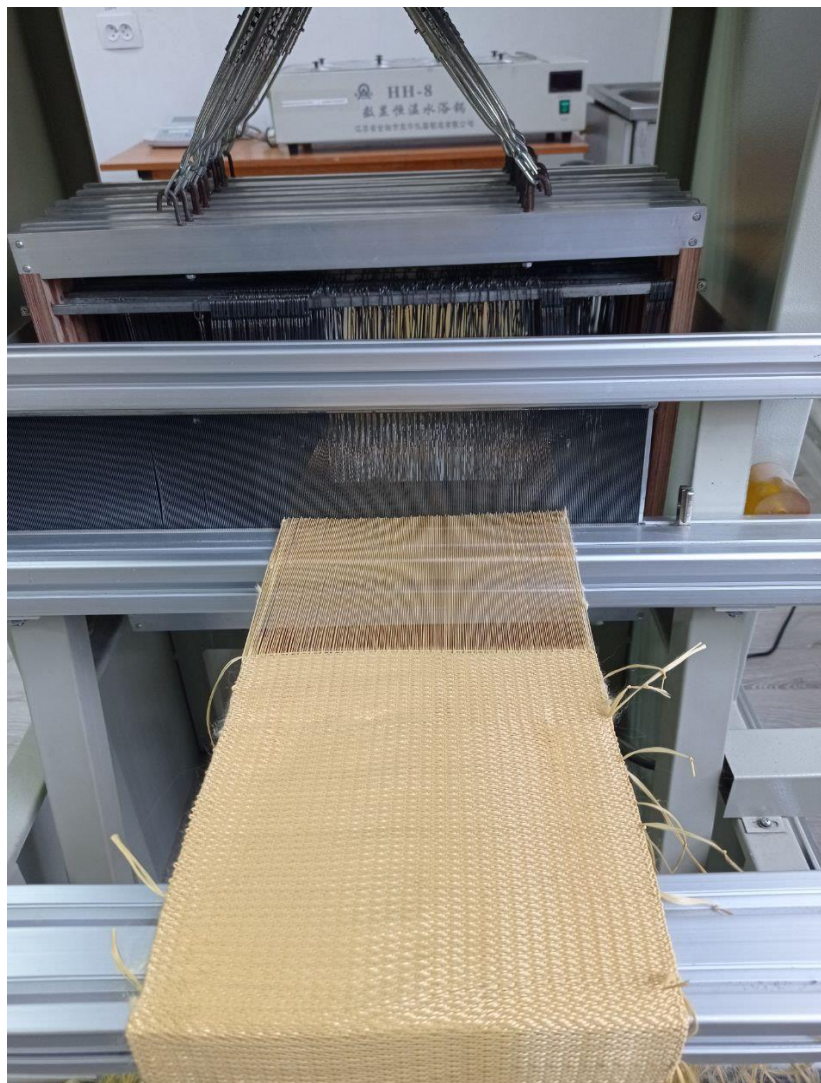
Расми 1. Тарзи истеҳсоли матои бисёрқабатаи арамидӣ дар дастгоҳи озмоишии нимхудкори тамғаи тамғаи АТ-246А
