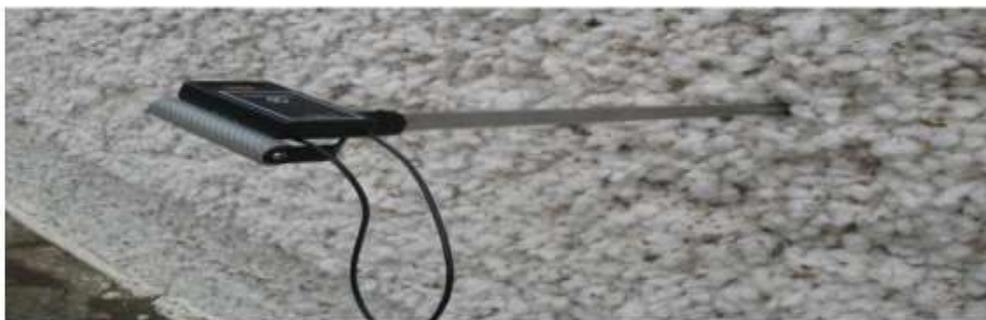
Рисунок 2. Установка термощупа в бунтах хлопка-сырца
