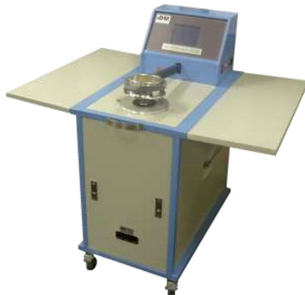
Рисунок 2.4 – Прибор для определения воздухопроницаемости A0003-PC (IDM, Швейцария)
