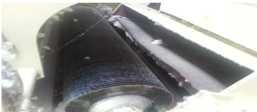
Рис.3. Пильный цилиндр автоматизированной волокноотделительной машины
