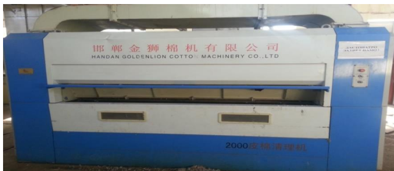
Рис.2. Пильный джин (автоматизированная волокноотделительная машина)
