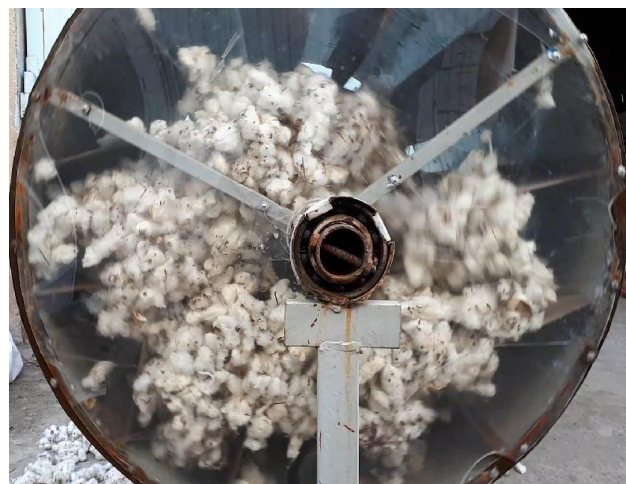
Рис. 5. Экспериментальная установка сушильного барабана с криволинейными лопастями
