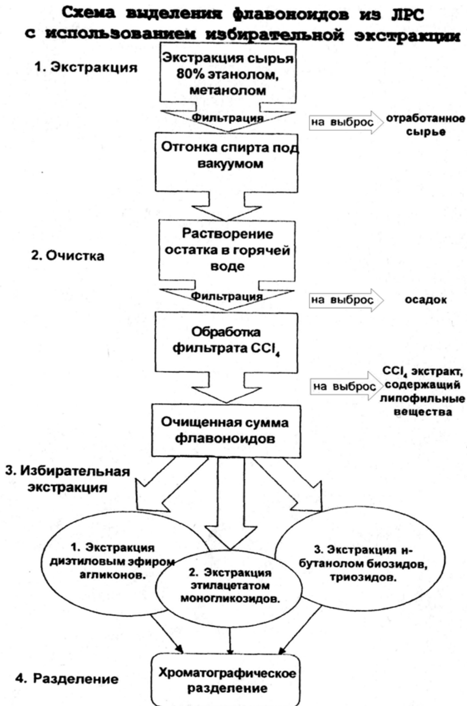
Рис.1 Схема выделения флавоноидов из растительного сырья с использованием избирательной экстракции
