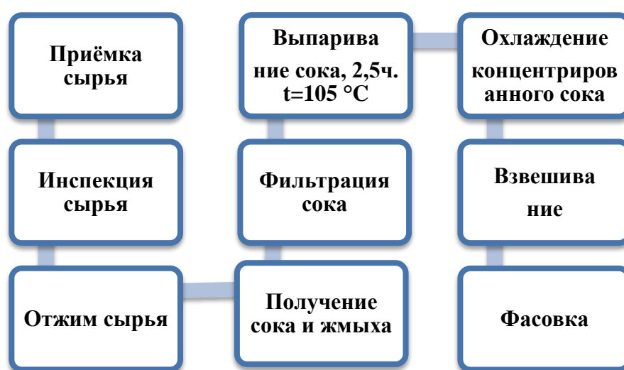
Рисунок 2. Блок-схема производства концентрированного сока из белого тута
