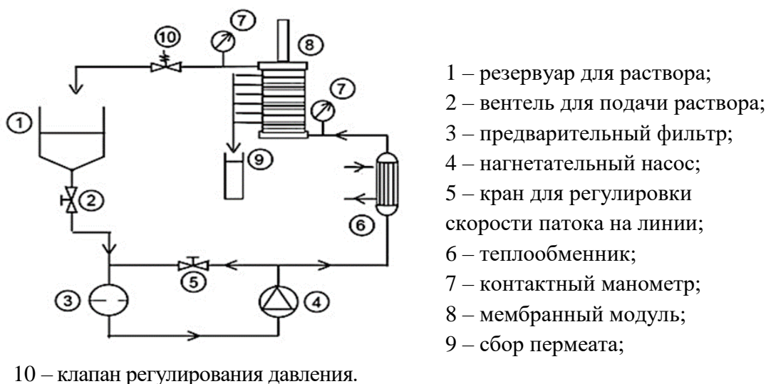
Рисунок 1. Принципиальная схема ТДУФ установки Материалы и методы
