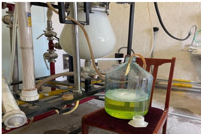
Рисунок 2. Пилотная ТДУФ установка (вид спереди), снабжённая УФ модулем из керамических мембран на основе Al_2O_3 с размером пор 1.4 мкм и TiO_2 с пределом отсека по молекулярной массе 10 кДа.
