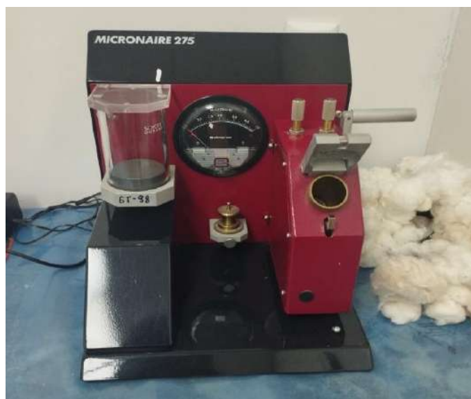
Рисунок 6. Прибор Микронейр для определения зрелости хлопка-волокна
