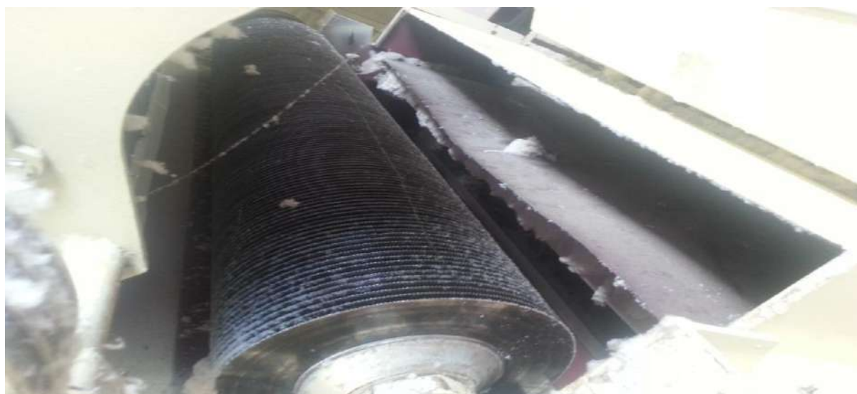
Рисунок 2. – Пильный джин (автоматизированная волокноотделительная машина)
