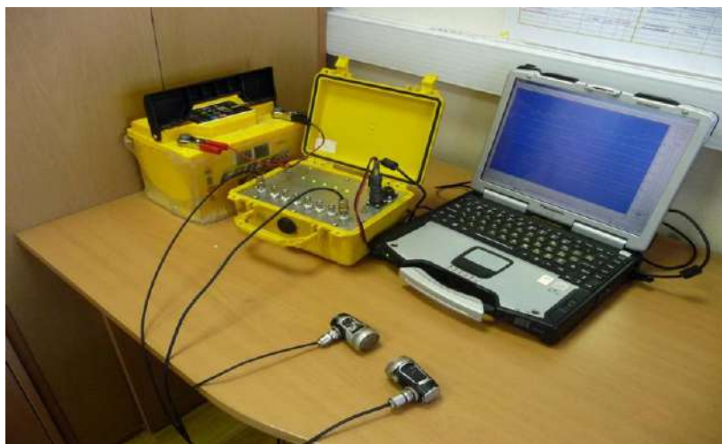
Рисунок 1. Комплект семиканальный ультразвуковой аппаратуры для исследования образцов
