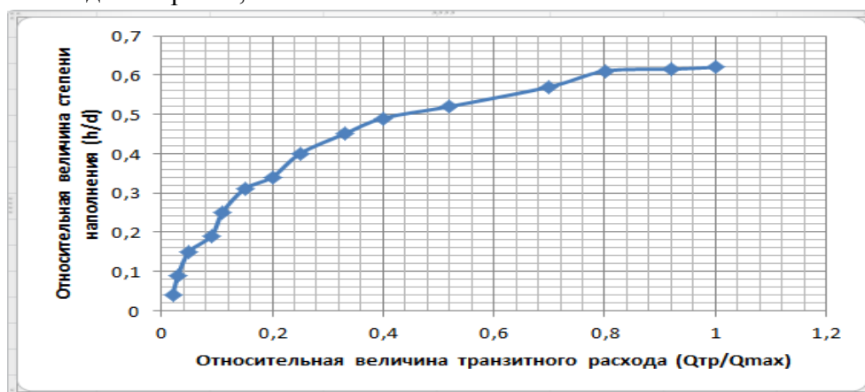
Рис. 3. Зависимость степени наполнения от транзитного расхода
