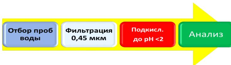
Рис. 1. Последовательность процессов по анализу воды
