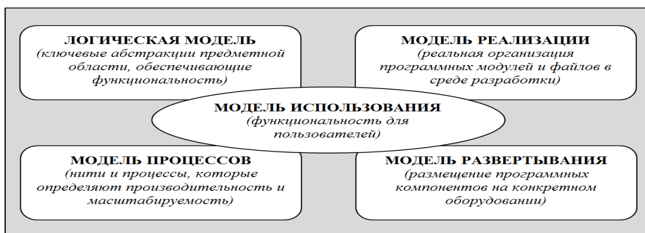
Рис. 1. Полная спецификация разрабатываемого программного обеспечения при объектном подходе (UML)
