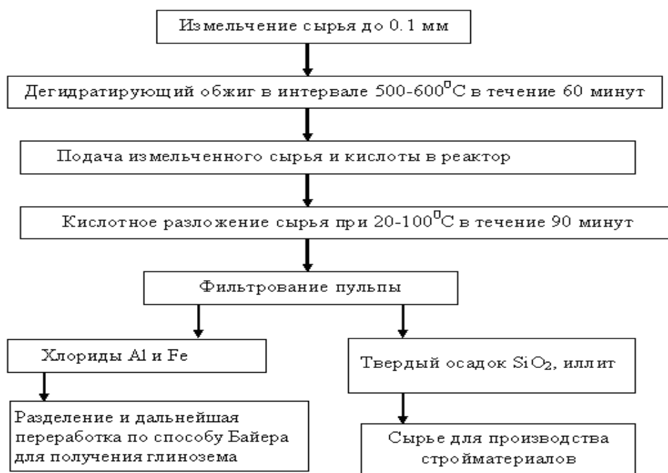
Рис.3. Принципиальная технологическая схема комплексной переработки аргиллитов месторождения Чашма-Санг солянокислотным способом.
