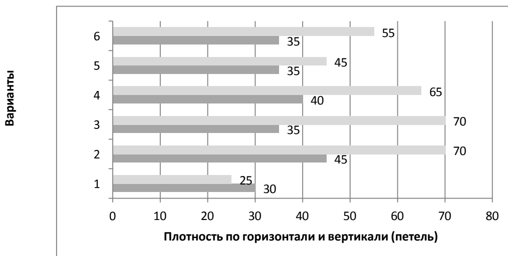
Рисунок 4. Диаграмма изменения плотности по горизонтали и вертикали вариантов жаккардового трикотажа
