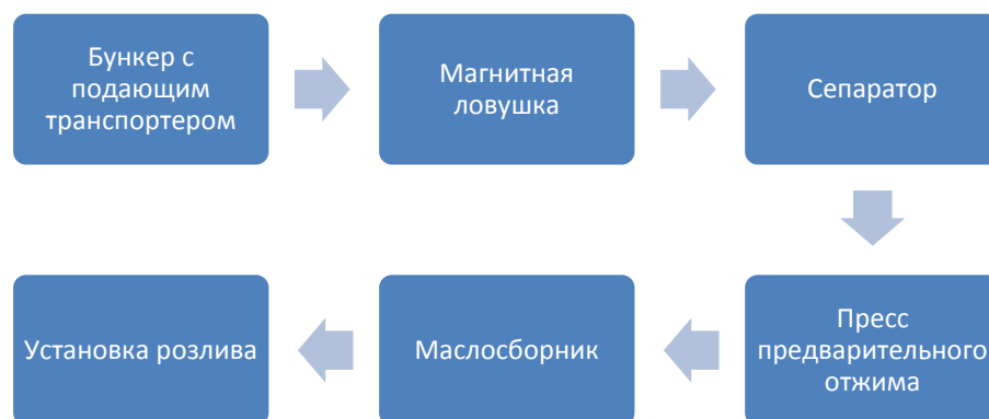
Схема 1. Технологическая схема поточной линии растительного масла
