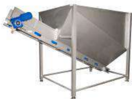
Рисунок 1. Бункер с подающим ловушкой ПЛС транспортёром тип АВТ
