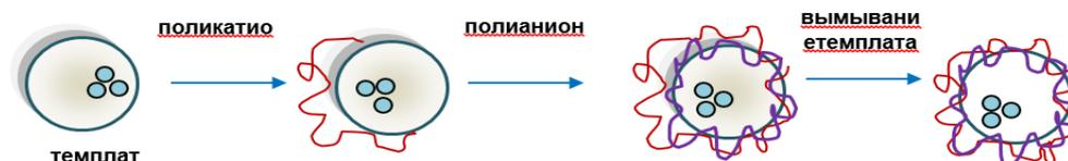
Рисунок 2. - Схема темплатного синтеза капсул
