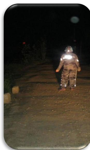
**Рисунок 4.** - Проверка дальности видения СВ элементов костюма при свете фар
