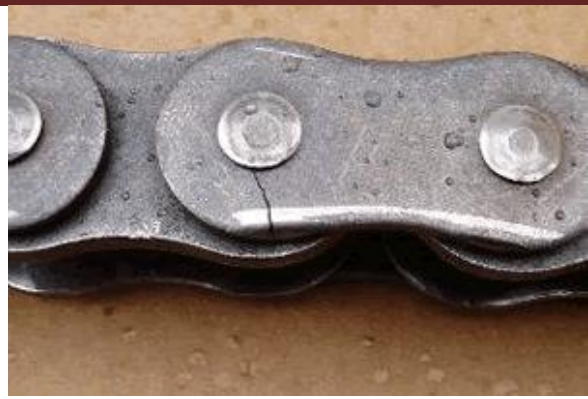
усталостное разрушение цепи
