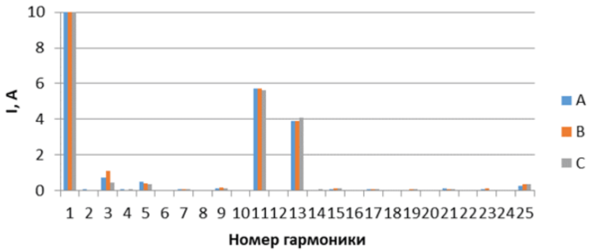
Рисунок 2. - Спектр тока СО УШРТ в режиме с максимальным THDi
