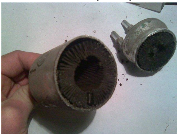
наносы в топливных и масляных магистралях
