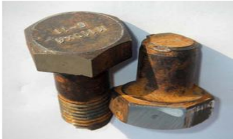
вязкое разрушение (растяжение и обрыв болтов)
