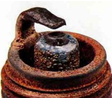
эрозионное изнашивание материала свечи
