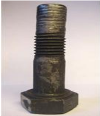
вязкое разрушение (растяжение и обрыв болтов)
