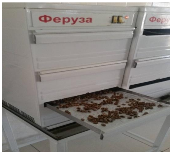
Расми 3. Гузариши раванди хушккунӣ дар хушккунаки лаборатории “Феруза”
