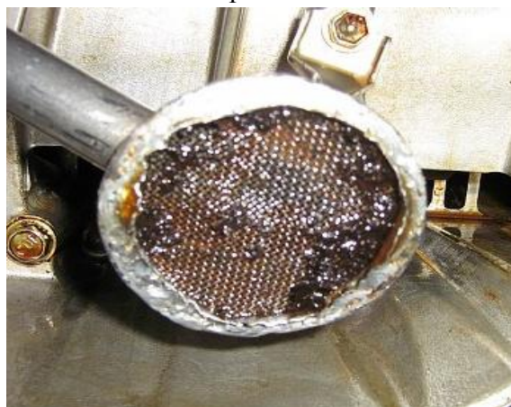
наносы в топливных и масляных магистралях
