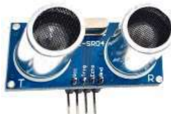
Рисунок 2. Ультразвуковой приёмопередатчик для Ардуино
