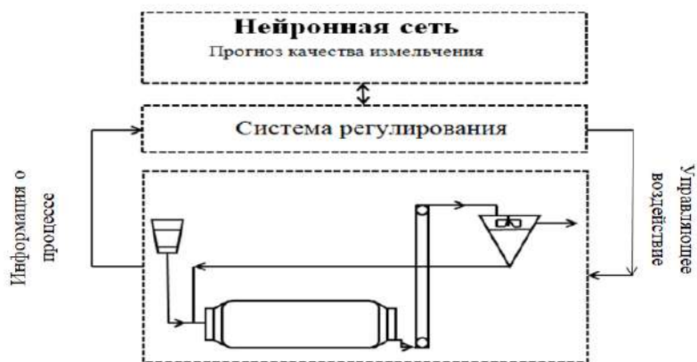
Рисунок 1. Структура системы управления процессом помола замкнутого цикла
