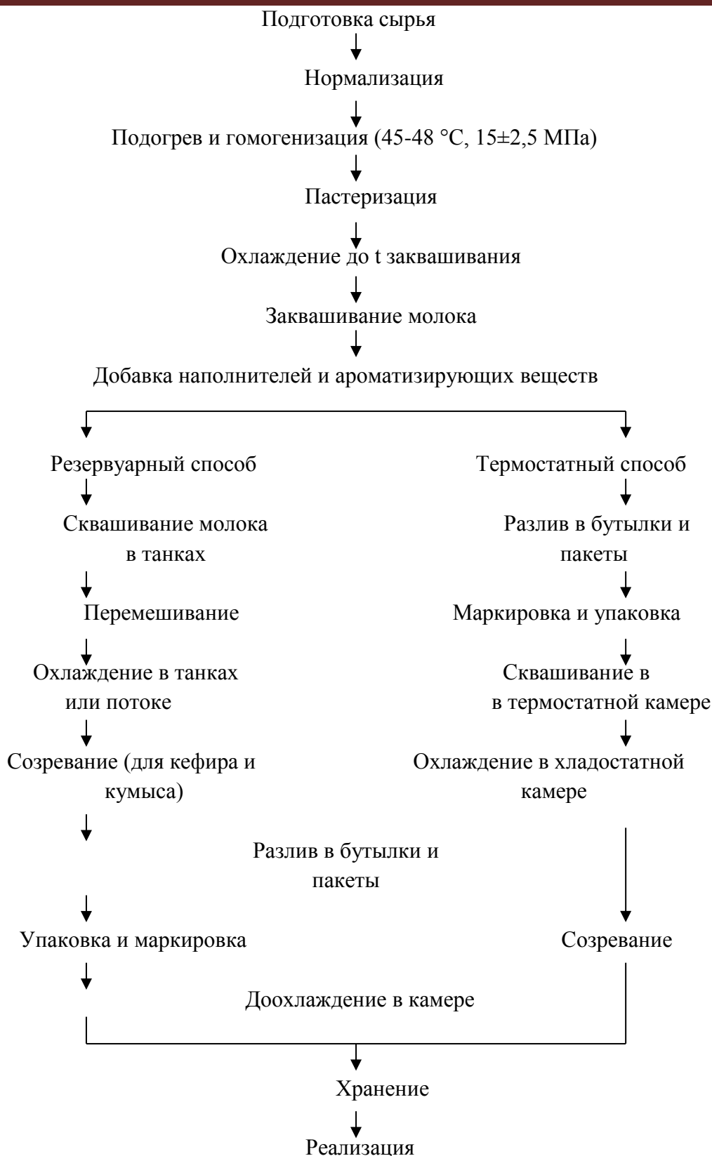
Схема 2. Технологическая схема производства кисломолочных напитков
