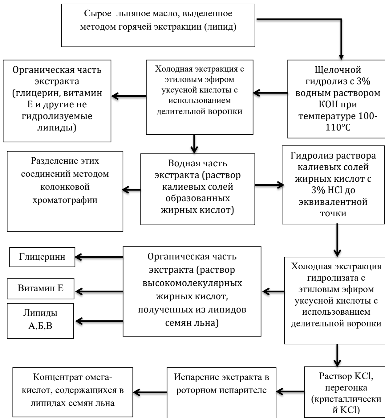
Рисунок 10. - Технология выделения омега-кислот из липидов семян льна
