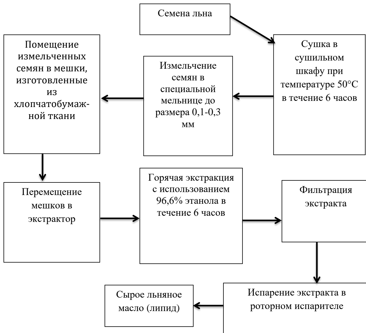
Рисунок 9. - Технологическая линия выделения липидов из семян льна методом горячей экстракции
