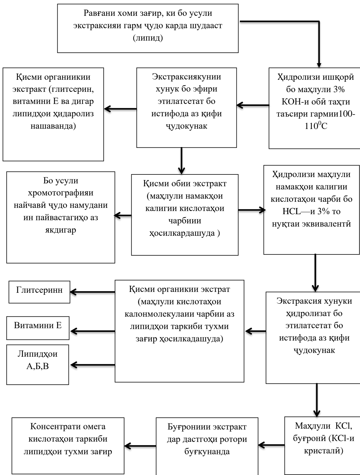
Расми 10. - Технологияи ҷудо кардани намудани омега кислотаҳо аз таркиби липидҳои тухми зағир
